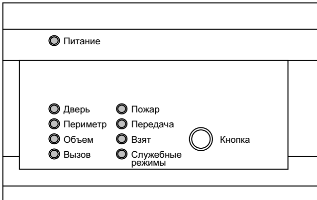
Рисунок 1. Внешний вид передатчика (надписи показаны условно)
